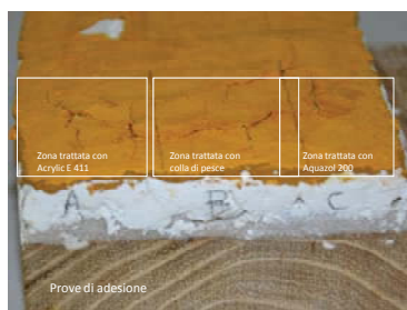
Figura 2. Prove di adesione sul provino n. 7
