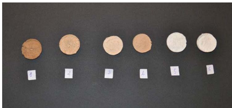
Figura 18. Provini per la scelta della stuccatura
