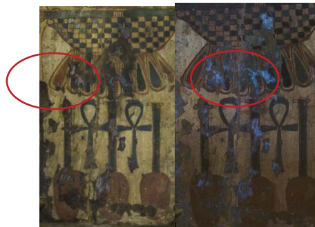
Figura 7. Le zone lucide a luce visibile e in fluorescenza ultravioletta indotta
