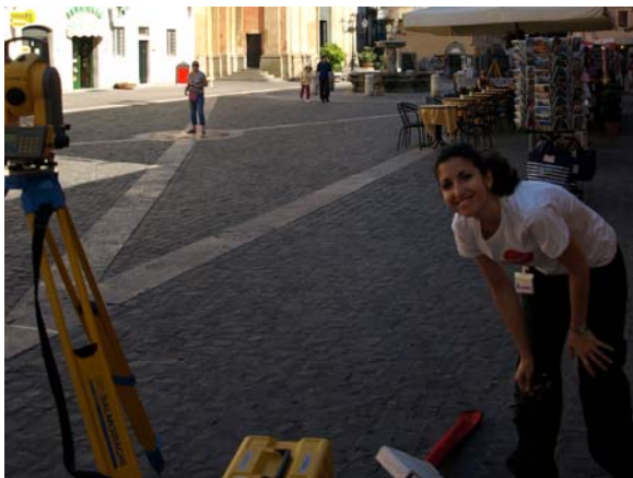
Castel Gandolfo, Chiesa di San Tommaso, rilievo con stazione totale dei prospetti esterni (Università degli Studi Roma Tre, DIPSA- Direzione dei Musei Vaticani, Ufficio di Sovrintendenza).
