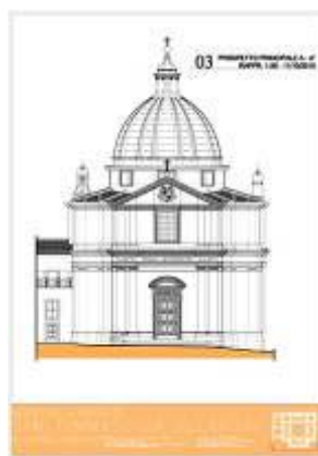
Il rilievo architettonico effettuato con stazione totale
